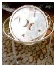
Strömungstafel, kardanisch aufgehängt Best.-Nr. 25.2188
