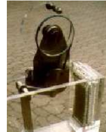
Handkurbelexzente r- getriebe mit Schwenkblech und rückwärtiger Dämpfung
